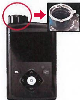
Slika: Mesto pritrditvenega obročka na inzulinski črpalci MiniMed serije 600
