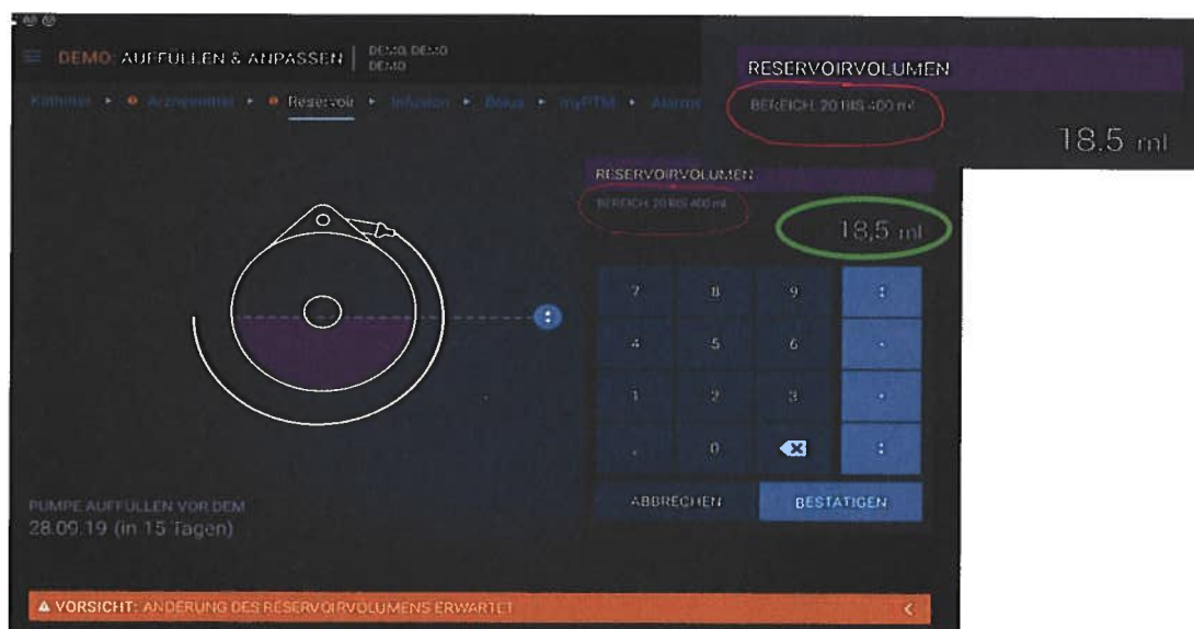
Slika1: Nepravilne vrednosti, prikazane za dovoljen razpon volumna rezervoarja (200–400 ml): Podatki, ki jih je vneslo zdravstveno osebje, so pravilni (18,5 ml)
