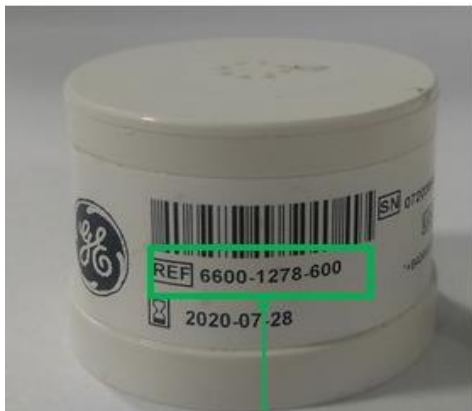
Slika 5: Številka dela senzorja za kisik: 6600-1278-600
