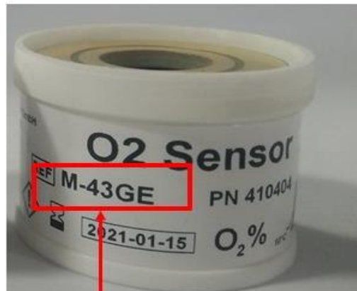
slika 6: Številka dela senzorja za kisik: M-43GE
