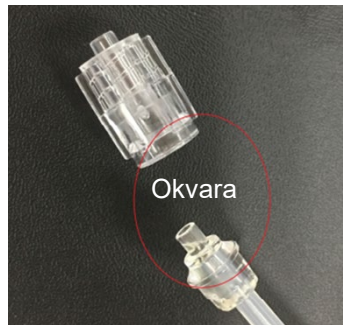
Slika 1. Okvara/ločitev zadevnega pripomočka na mestu nezadostnega zvara
