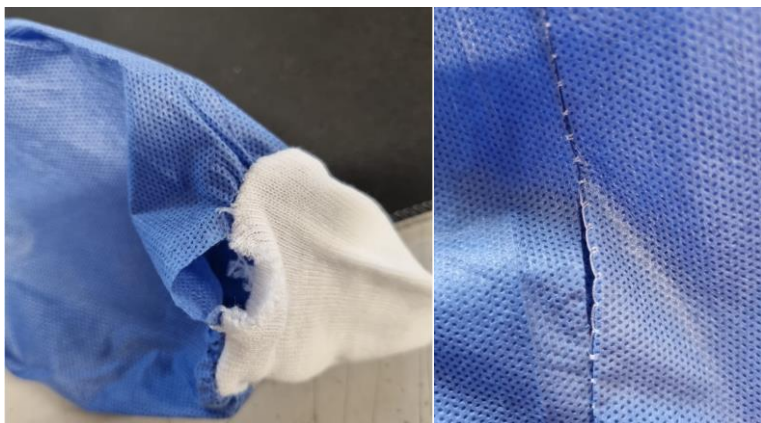
Slika 1: Napaka pri šivanju manšete in šiva
