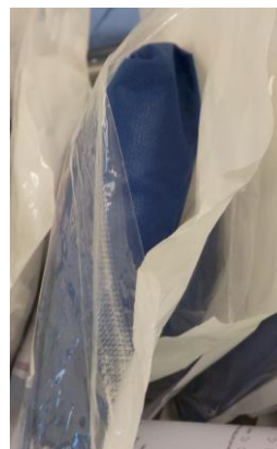
Slika 2: Napaka odprte vrečice
