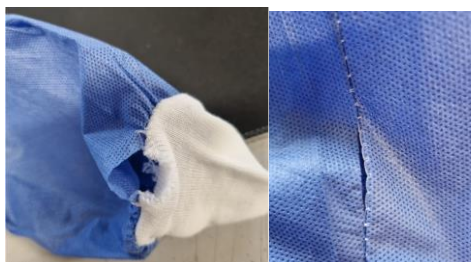
Slika 1: Napaka pri šivanju manšete in šiva
