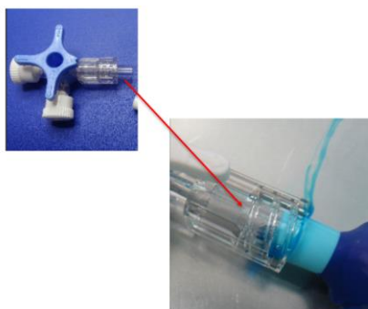
Slika 1: Potencialno mesto puščanja na ohišni komponenti zapornega ventila
