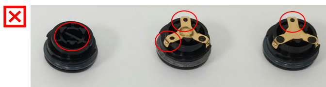
Poškodovani pokrovčki baterije - ne uporabljajte Kovinski kontakt manjka ali pa so prisotne manj kot 3 dvignjene pike.
