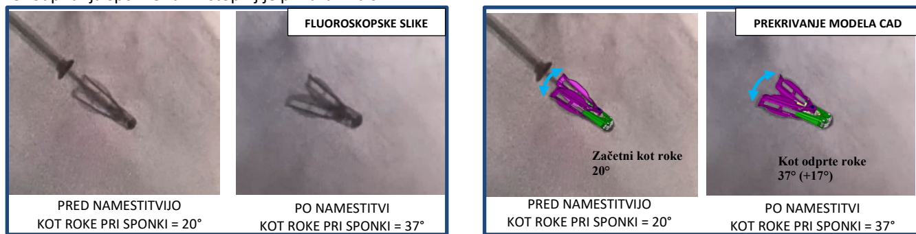
Slika 1: Fluoroskopska slikovna obdelava odpiranja sponke, medtem ko je zaklenjena (COWL) ob namestitvi (levo) s prekrivanjem modela CAD (desno)
