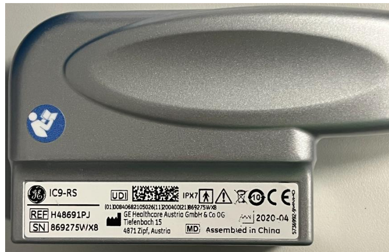
Slika 4. Primer nazivne ploščice – navedba vrste sonde (IC9-RS) in serijske številke (SN).
