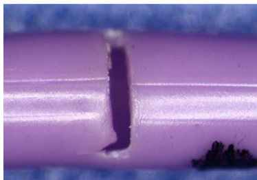
Slika 1: Primer prečne/obodne razpoke v telesu katetra
