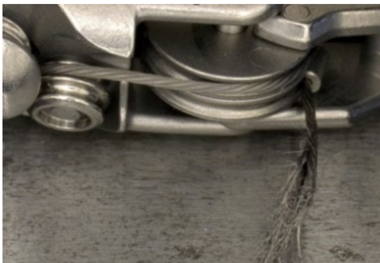
Slika C: 20-kratna povečava pretrganega kabla za oprijem na instrumentu da Vinci Xi.
