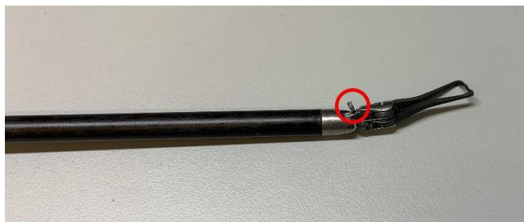
Slika F: Pretrgan kabel za nagib
