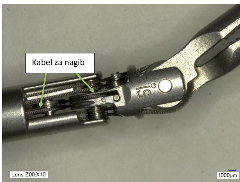
Slika B: 10x povečan primer nepoškodovanega kabla na majhnem prijemalnem retraktorju da Vinci Xi.
