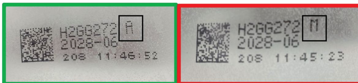
Slika 2. označevanje vreč smartbag – podrobnosti. “A” za serijsko številko predstavlja vreče smartbag, polnjene na liniji A in se lahko uporabijo. “M” za serijsko številko predstavlja vreče smartbag polnjene na liniji M in se ne smejo uporabiti!
