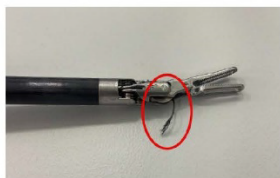
Slika H: Pretrgan kabel
