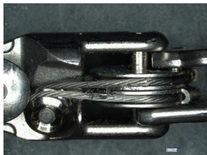
Slika D: 20-kratna povečava obrabljenega kabla za oprijem na instrumentu da Vinci Xi
